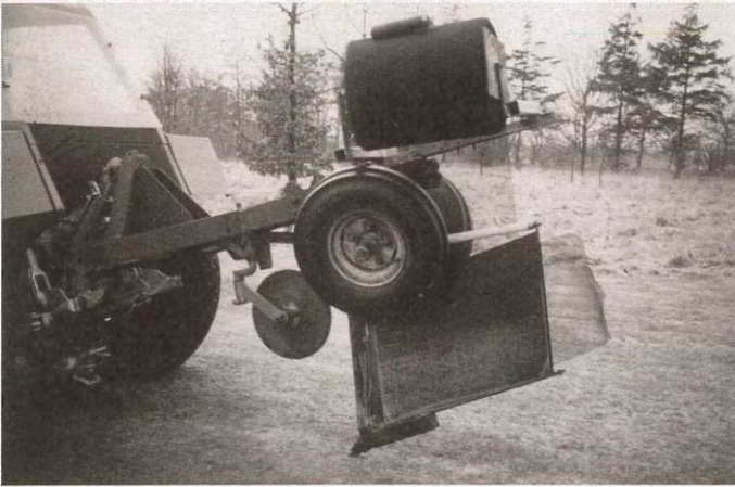
Abb. 1: Vorlegegerät für den „Maulwurfzaun“ mit vorschneidendem Scheibensech und Tiefenschar
